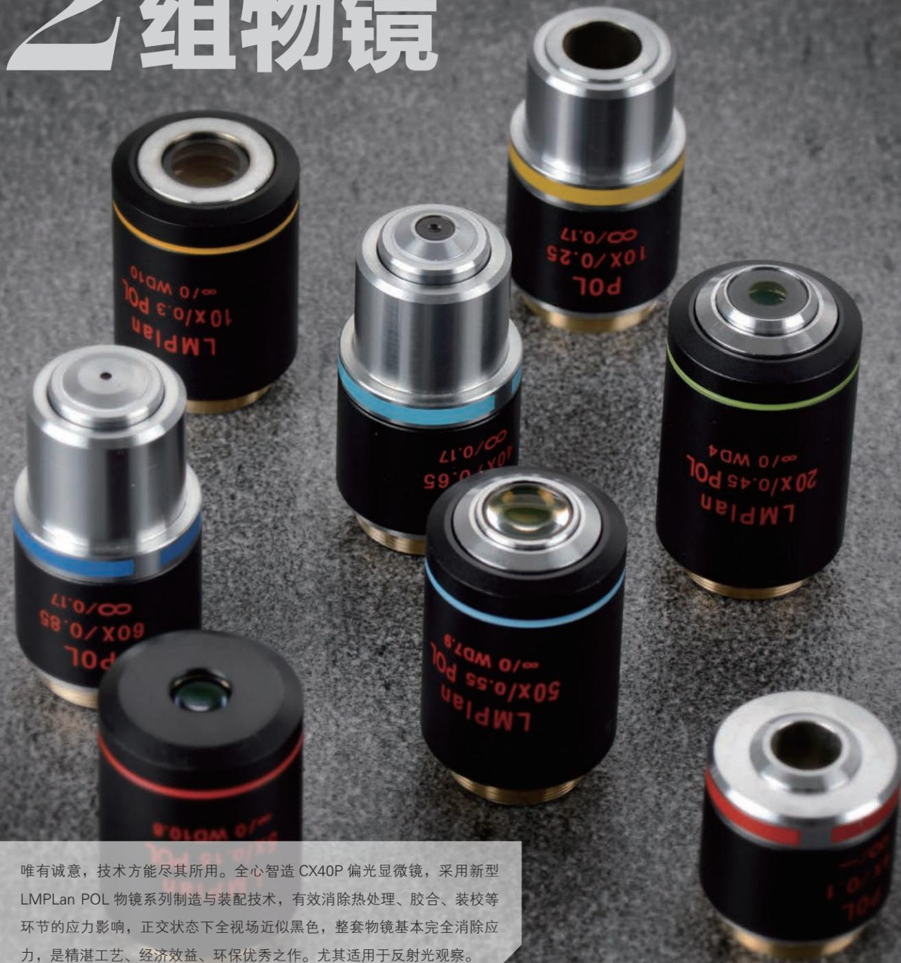
唯有诚意，技术方能尽其所用。全心智造 CX40P 偏光显微镜，采用新型 LMPlan POL 物镜系列制造与装配技术，有效消除热处理、胶合、装校等环节的应力影响，正交状态下全视场近似黑色，整套物镜基本完全消除应力，是精湛工艺、经济效益、环保优秀之作。尤其适用于反射光观察。
