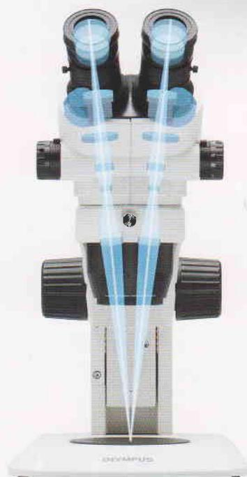
格里诺光学系统有 2 个向内倾斜 10° 的光路，这让设计高性能的紧凑型显微镜成为了可能。
